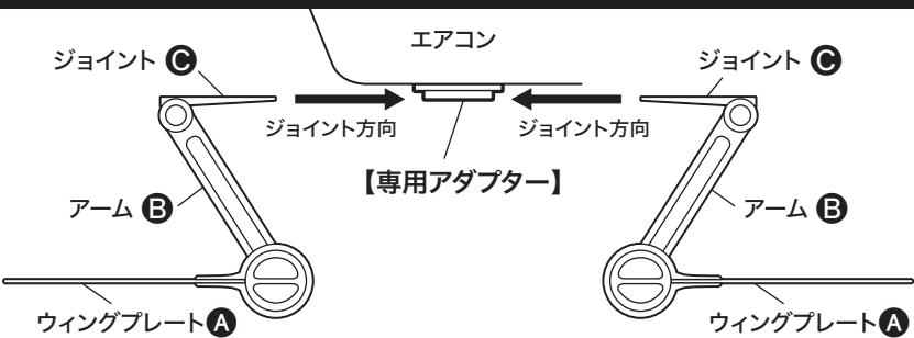
**冷房時** ウィングプレートAの角度を調整し、下の方に溜まりやすい冷気を遠くに飛ばして部屋全体へ送ります。
