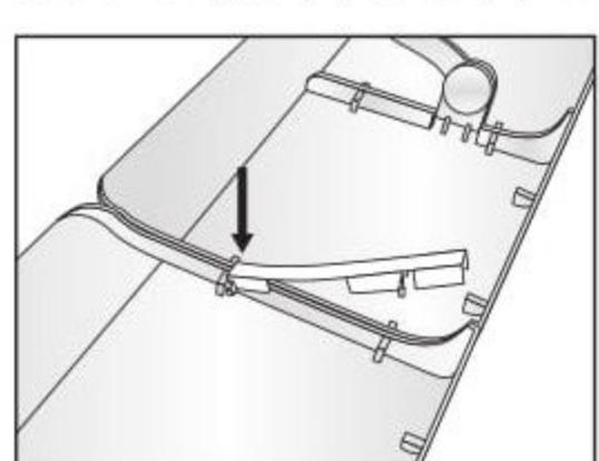
ジョイントクリップ端の突起を本体サイドの手前の爪に差し込む。
