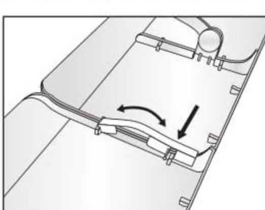
ジョイントクリップを少したわめて、切り欠き部分の突起を本体サイドの奥の爪に差し込む。
