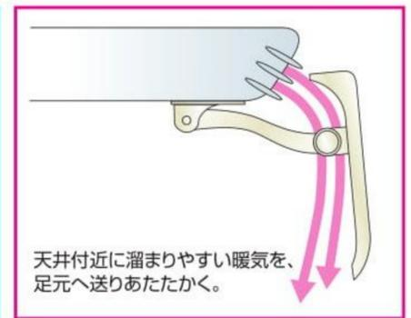
※アダプターへのジョイントの差込方向を変えて、本体の向きを変えるだけで冷房にも暖房にも対応。また、ネジを外してジョイント部の取り付け方向を変えることも切り換えができます。
